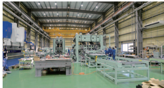
第二工場では組み立て中のパネル折り曲げライン
