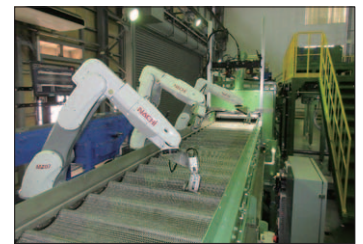
写真-4 フォーマーに連動させた SP ロボット®
