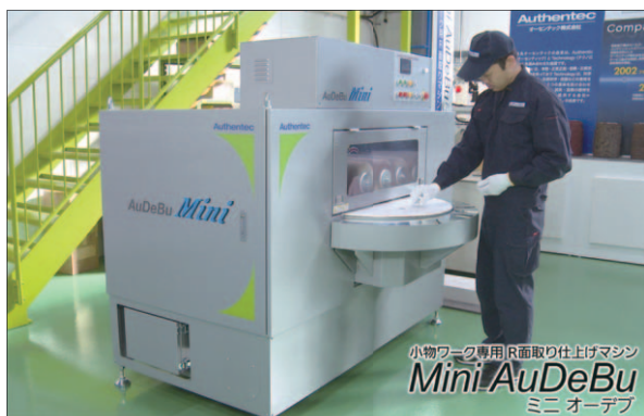
●ワークの搬入・搬出が容易なターンテーブル方式を採用
