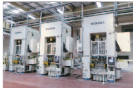
300トントランスファプレス 3連ライン
