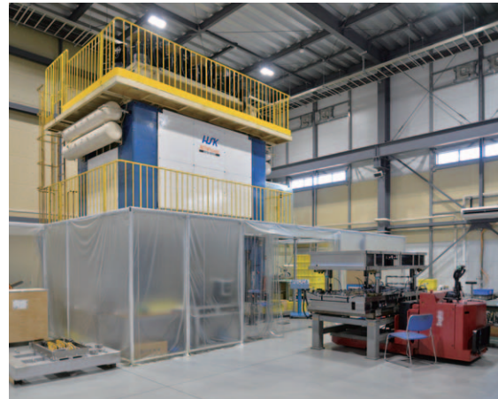
直動式デジタルサーボプレス ダブルスライド1000tタイプ ZEN Former MPS81000DS
