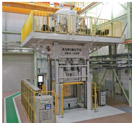
自社開発したCFRP大型試作用成形機『HR4-10SP』
