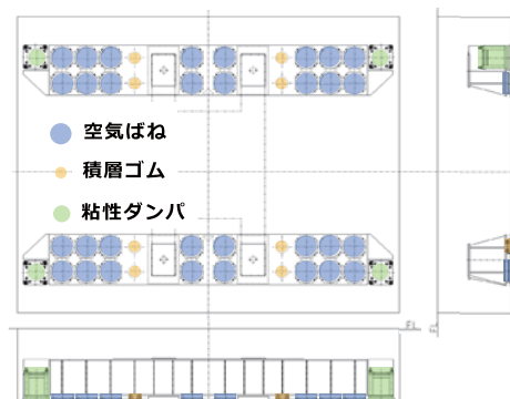
図3.全体レイアウト (空気ばね+積層ゴム+粘性式ダンパ)
