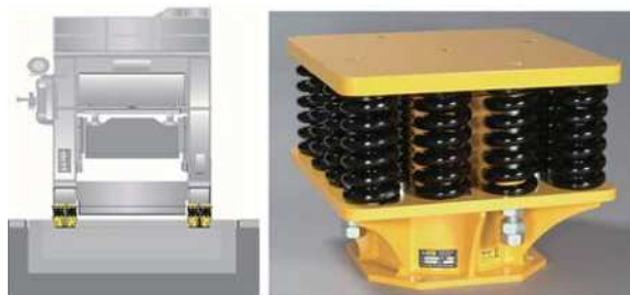
図2. プレスに対する防振の例
