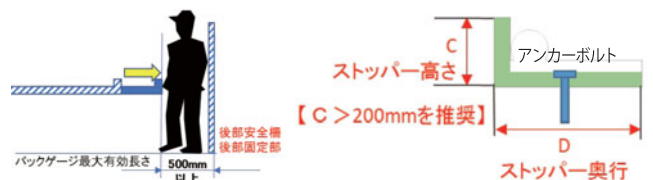
図 7. 挟まれ回避のための最小隙間の確保 (JIS B 9711, ISO 13854)
