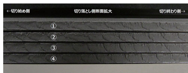
写真2 : 1470MPa 2mm鋼の切断事例
