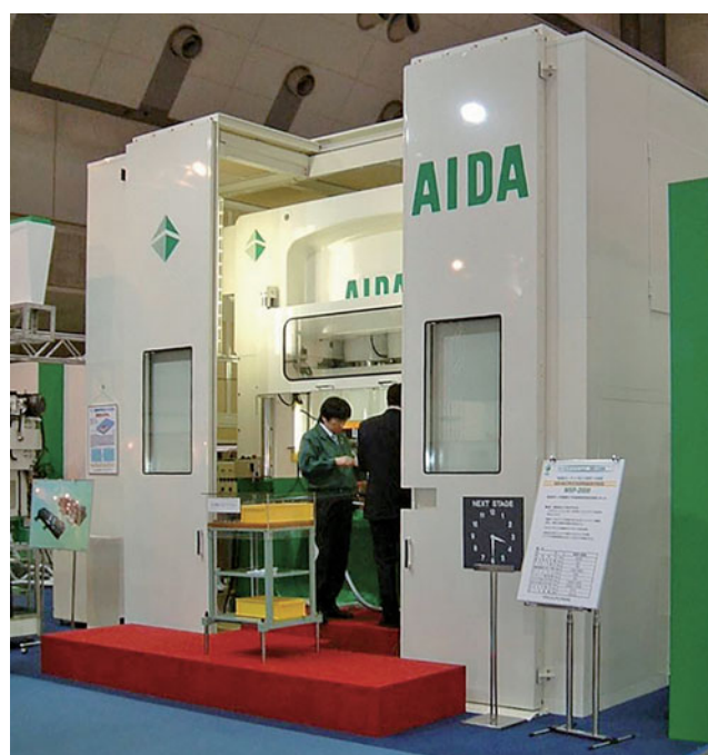
アイダエンジニアリング(株)様 展示会出展機用防音装置
