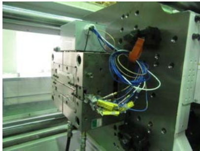
スマート金型に搭載されたデータ収集装置
