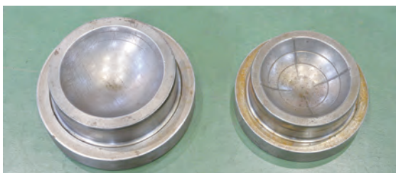
分解して判るボールカップの磨耗
