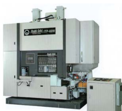
スマートフォン用リチウムイオン電池ケースの 加工用最新鋭トランスファープレス iTP-60W
