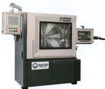
成形スライドのカムレスを実現。 最新鋭NCマルチフォーミングマシン F3
