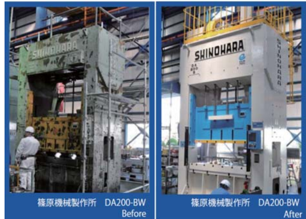
リビルト・ラボによるプレス機再生
