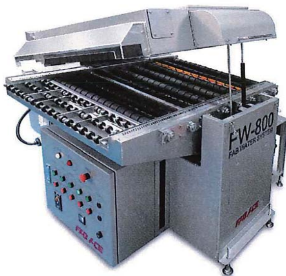
MF-Tokyo 2017に参考出品し好評を得た 板金加工用アルカリ電解水平板洗浄装置FW-800 来年4月より本格的に販売開始予定
