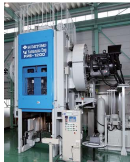
冷間鍛造サーボプレス FPS シリーズ 多軸成形機構で難加工素材・複雑形状に対応。
