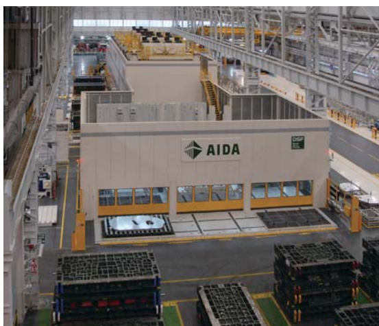
海外で稼働するオールサーボタンデムライン
