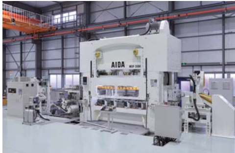
マルチサスペンション採用の高速自動プレス
